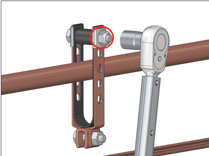
Die Sicherungsmutter mit 25 Nm anziehen.
